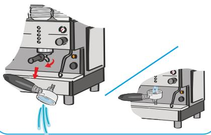
Siebträger entfernen. Starten Sie den Brühzyklus und spülen Sie den Siebträger mit Wasser aus der Maschine aus. Halten Sie den Zyklus an. Setzen Sie den Siebträger in die Maschine. Starten Sie den Brühzyklus und lassen Sie ihn 10 sek laufen. Halten Sie ihn anschließend 10 sek an. Wiederholen Sie den Vorgang 5 mal. Brühen Sie einen Espresso auf und schütten Sie den ersten Espresso weg, um sicherzustellen, dass keine Rückstände verbleiben.
