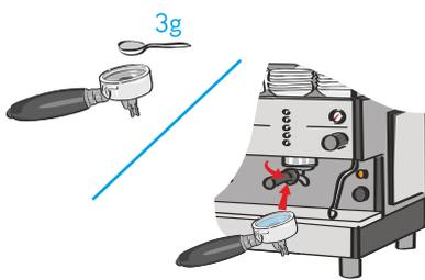
Setzen Sie das Bindsieb in den Siebträger und geben Sie SUMA Cafe Powder hinzu. Setzen Sie den Siebträger in die Maschine ein. Starten Sie den Brühzyklus und lassen Sie 10 sek laufen, halten Sie anschließend 10 sek an. Wiederholen Sie den Vorgang 5 mal.
