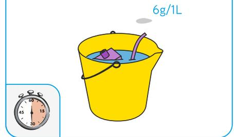
Lösen Sie SUMA Cafe Powder in heißem Wasser auf. Lassen Sie die Siebe und das Metall des Siebträgers 30 min einweichen. Mit sauberem, heißem Wasser abspülen.
